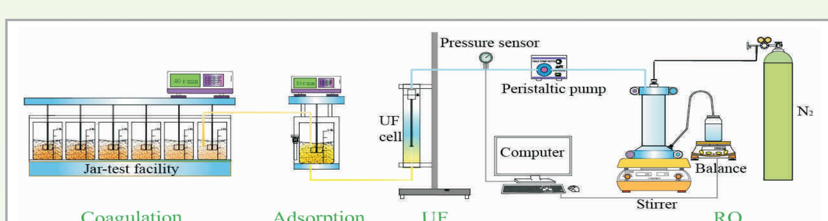
混凝-吸附-超滤-反渗透联用技术
