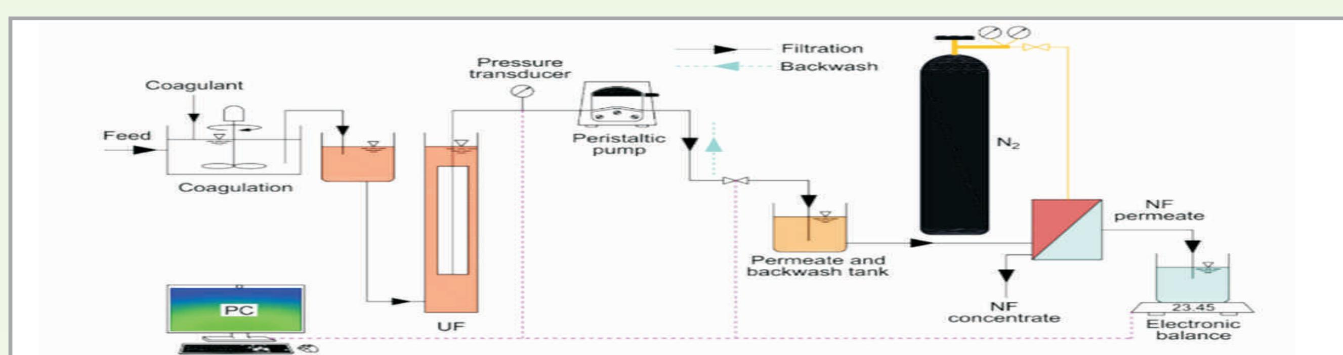
混凝-超滤-纳滤联用技术
